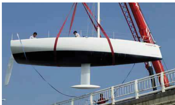
In questa foto in evidenza il dettaglio della chiglia a T, con lama in carbonio, dal pescaggio di 1,75 m.
